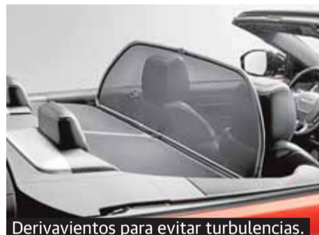
Derivavientos para evitar turbulencias.
